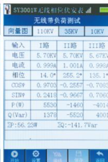
无线带负荷测试-110KV
