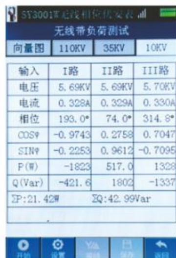
无线带负荷测试-10KV
