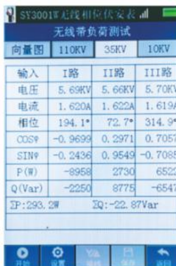
无线带负荷测试-35KV
