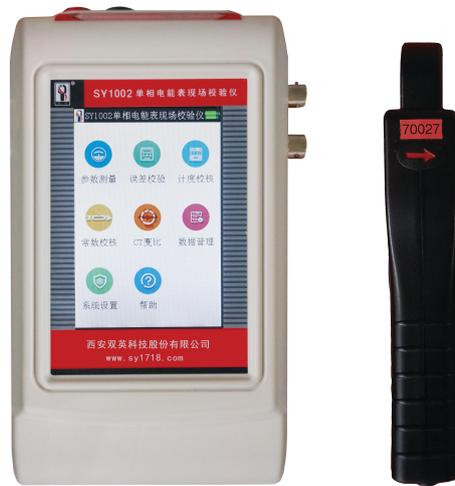
最新手持式单项电能表现场校验仪，彩色触摸屏显示
