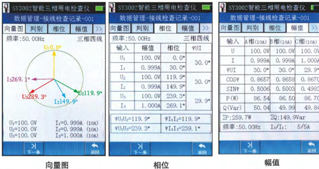
3、判别视图窗口，显示的关于本次测量结果的三相三线制 192 种和三相四线 2304 种接线错误判定情况，用户可分别选择查看标准向量图，接线图和结果说明。
